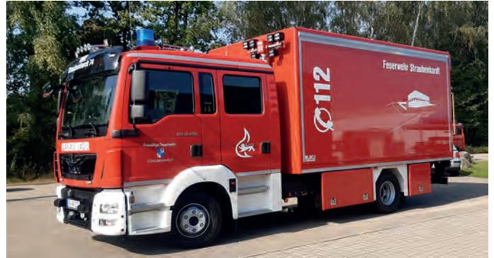
Der Kofferbauaufbau verfügt über eine geteilte Ladebordwand und einen Seiteneinstieg zum sicheren Be- und Entladen. In der Mannschaftskabine finden sechs Feuerwehrangehörige Platz und im Aufbau sind einige Werkzeuge z.B. Besen, Schaufel und Brechwerkzeug sowie Verkehrssicherungsmaterial gelagert. Weitere benötigte Ausrüstung kann individuell je nach Einsatzlage über Paletten und Rollwagen verladen werden.
